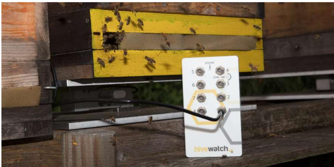
Siempre y cuando los enchufes estén correctamente alineados, estos se podrán atornillar fácilmente y sin gran resistencia. **Como este es un sistema de medición extremadamente preciso, es importante asegurarse de que los contactos del enchufe no están sucios bajo ninguna circunstancia ni entren en contacto con el agua.** Por esta razón, realice la instalación en buen tiempo, para que la humedad y suciedad no entren en los enchufes.
